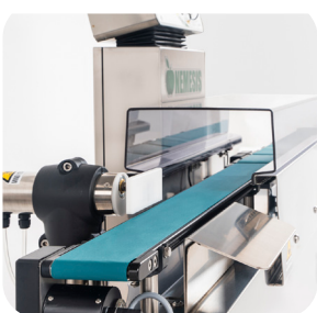
Tunnel di protezione Essenziale per gli standard GMP nel farmaceutico, garantisce igiene e sicurezza.
