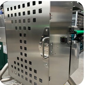
Cesto di scarto in acciaio con serratura automatica Sempre in acciaio, ma con chiusura comandata dal pannello di comando.
