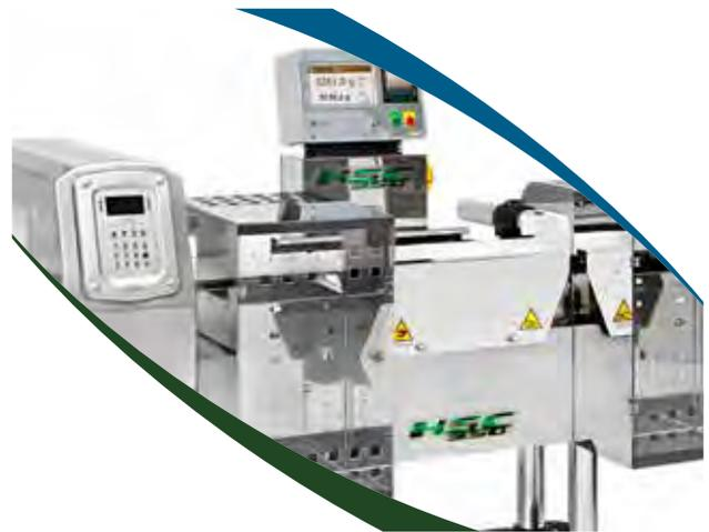
Le selezionatrici a **pesatura di picco** necessitano di una spaziatura tra i prodotti superiore alla lunghezza del nastro di pesatura. Per le selezionatrici **EasyWeigh®** è sufficiente che il passo tra i prodotti sia di poco superiore alla lunghezza del nastro di pesatura.
